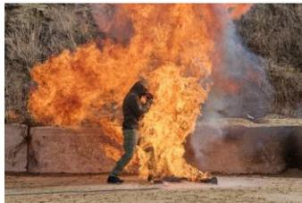
Improvisierte Sprengsätze (Improvised Explosive Devices, IEDs) sind eine Bedrohung für Soldaten in weltweiten Einsätzen. Im Test: eine PYRAD® Kampfkleidung by GORE-TEX LABS, konfrontiert mit zwei großen Gasexplosionen und einer kontinuierlich brennenden Gasflamme als Wärmequelle sowie Lycopodium als zusätzlicher Feuereffekt im Hintergrund.
